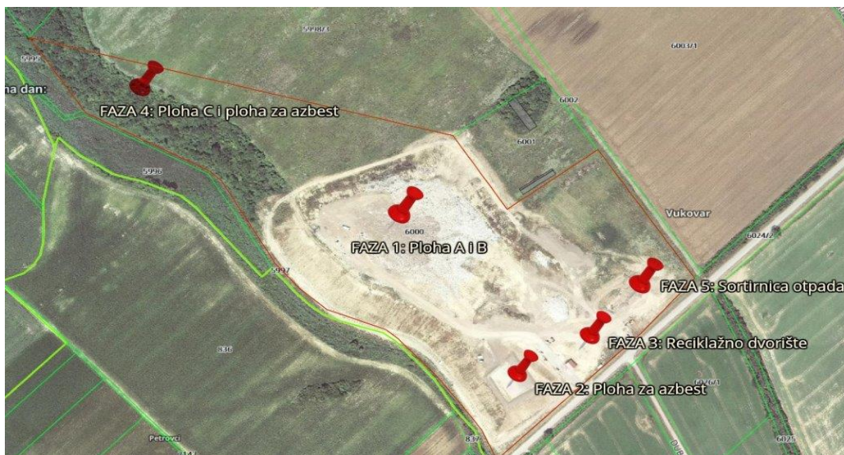
Slika 15. Prikaz sanacije odlagališta otpada na k.č. 6000 k.o. Vukovar
